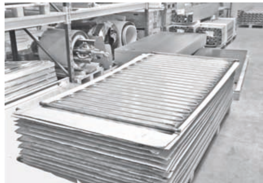
Kupferrohrschlangen zum Einbau bereit.
