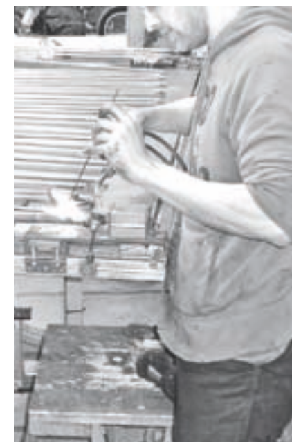
Zusammenlöten eines Kollektors.
